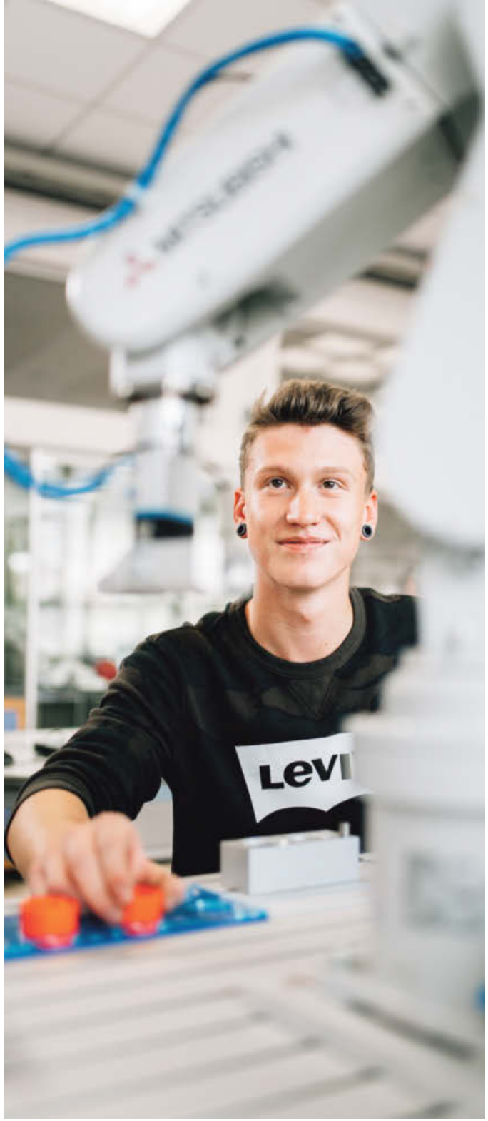
Intelligente Produktion: Ein Azubi beim Programmieren und Anlernen eines Knickarm-Roboters für Montageaufgaben.
