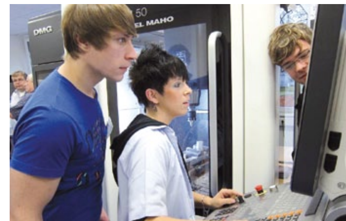
Zerspanungsmechaniker (3. Ausbildungsjahr) an einer CNC-Universal-Fräsmaschine mit fünf Bearbeitungsachsen
